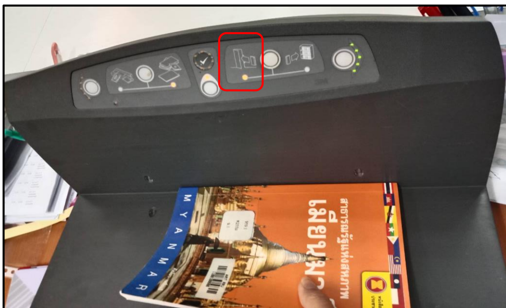
ภาพที่ 3.18 แสดงการลบสัญญาณแม่เหล็กจากตัวเล่มหนังสือ
