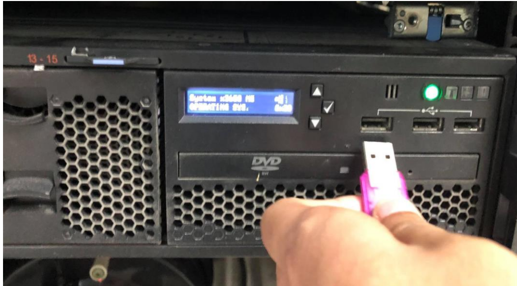
ภาพที่ ๓.๖ การเชื่อมต่อ Flash Drive กับช่อง USB
