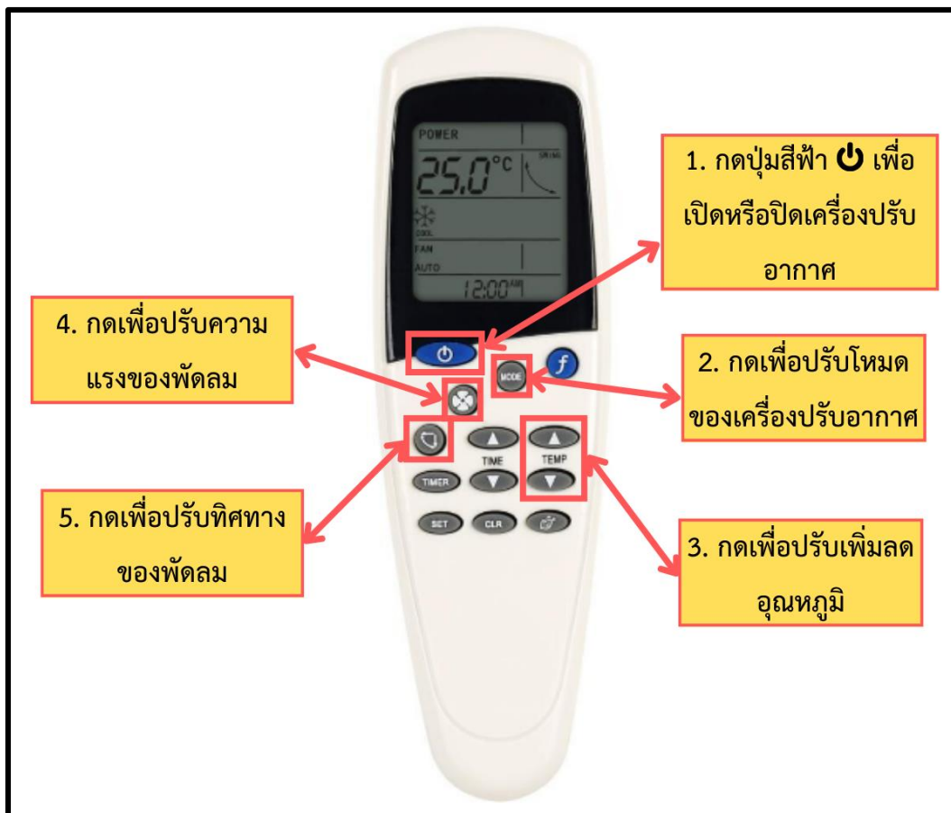
ภาพที่ 3.11 วิธีการใช้งานรีโมทของเครื่องปรับอากาศ
