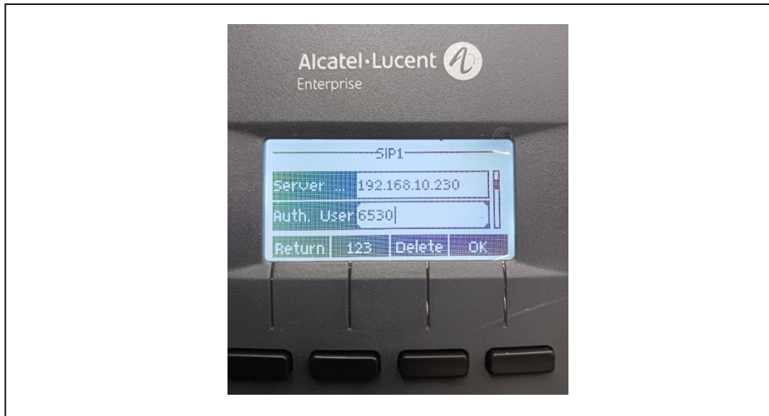
ภาพที่ 3.49 หน้าจอโทรศัพท์ผ่านเครือข่ายอินเทอร์เน็ตใส่หมายเลขโทรศัพท์ใหม่ที่สร้างไว้
