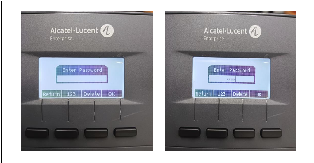
ภาพที่ 3.43 หน้าจอโทรศัพท์ผ่านเครือข่ายอินเทอร์เน็ตเพื่อเข้าโหมดการตั้งค่า
