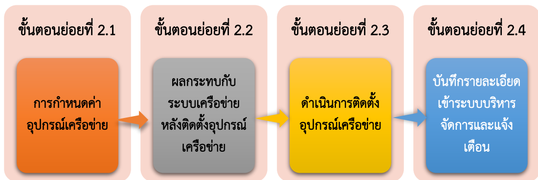
ภาพที่ 3.8 กระบวนการติดตั้งอุปกรณ์เครือข่ายประเภทอุปกรณ์กระจายสัญญาณเครือข่าย
